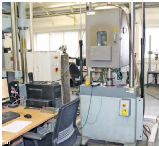
Bild 3 Messung einer Hysteresekurve: a) der Versuchsstand und b) die Kraft-Verformungskurve Hysteresis curve measurement: a) experimental setup and b) force-deformation curve
